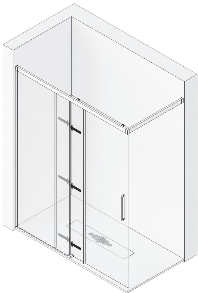
AJUSTAR EL JUEGO DEL VIDRIO FIJOS SEGÚN NECESIDAD. FIJAR EL VIDRIO, ENGOMANDO EL CRISTAL CON EL PERFIL A PARED Y CON LA GUIA SUPERIOR.
